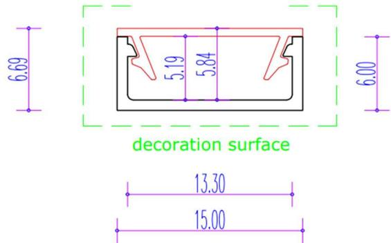
Materialzusammensetzung von 6063-T5 Aluminium Legierung | pulverbeschichtet | recyceltes Aluminium
